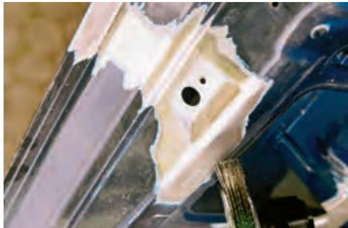
Rimozione della vernice dai profili.
